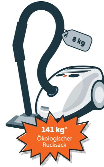
**Beim Staubsauger** kommen zum größten Teil verschiedenste Kunststoffe zum Einsatz. Außerdem geringere Mengen an Stahl und Kupfer. Neben diesen Metallen spielen jedoch auch die Endfertigung (Stromverbrauch der Produktion) und die Herstellung von technischen Textilien (z. B. Filter) eine wichtige Rolle (zusammen etwa 40 % des Rucksacks).
