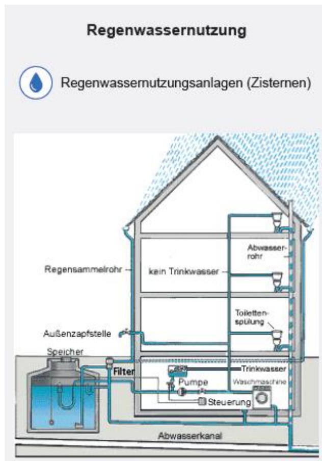
Regenwassernutzung im Haus Vaz de Miranda, Kovalkova, Brusser, Kim, 2022
